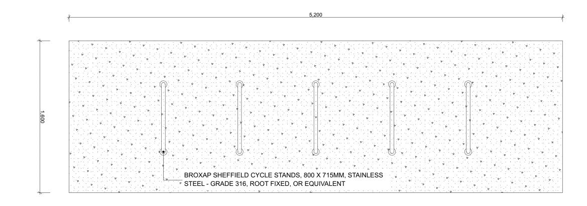
**Detail 13. Cycle stand installation detilas** 1:20
