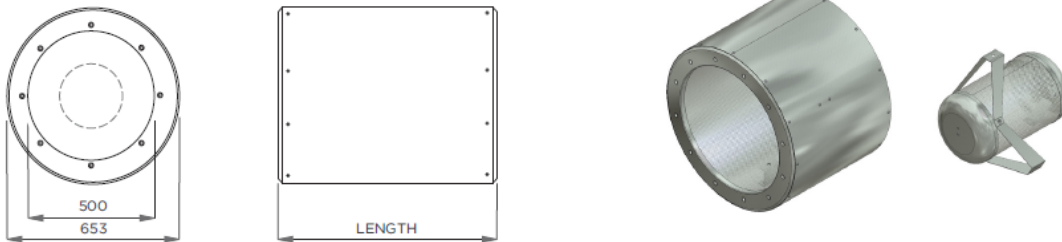
PATTERN A - 12 x M10 - 560 PCD PATTERN B - 12 x M8 - 541 PCD
