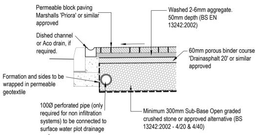
PERMEABLE BLOCK PAVING CONSTRUCTION DETAIL (SHARED DRIVE FALLING TOWARDS HIGHWAY)
