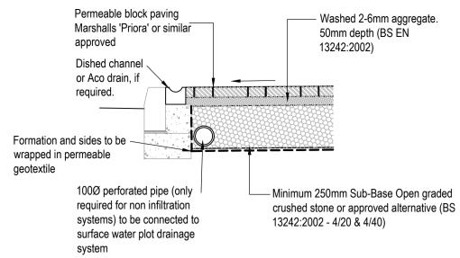
PERMEABLE BLOCK PAVING CONSTRUCTION DETAIL (PRIVATE DRIVE FALLING TOWARDS HIGHWAY)
